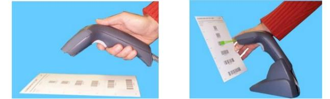
Avec les pistolets Heron™, la lecture des codes s'effectue automatiquement et à distance. Il suffit de viser le code et d'appuyer sur la gâchette. Le faisceau sortant de la fenêtre de lecture de l'appareil lit le code. Ce faisceau doit être centré sur le code à barres à lire et doit le traverser de part en part.
