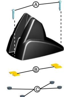
Pour le montage du support il est possible également d'utiliser des vis fileées, des bandes adhésives ou des petits patins en caoutchouc:
